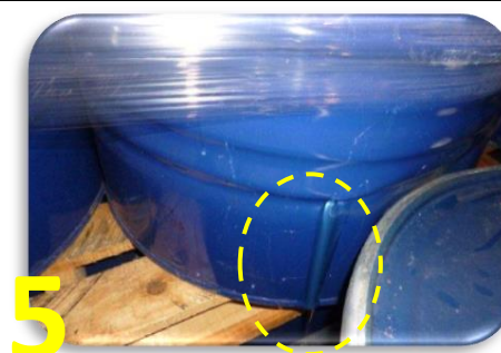
Tambor con derrame de producto.
