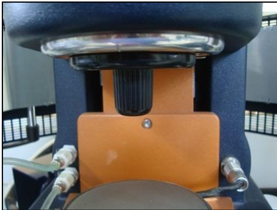
Imagen 10: Retirar seguro (" draw rod ") ; parte inferior
