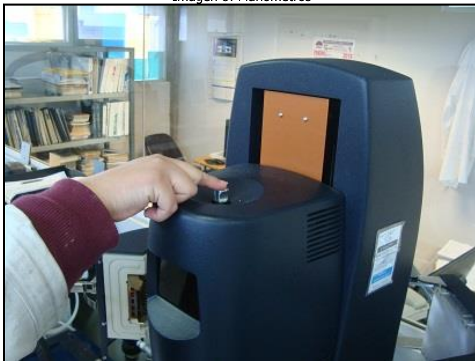
Imagen 9: Retirar seguro (" draw rod "); parte superior
